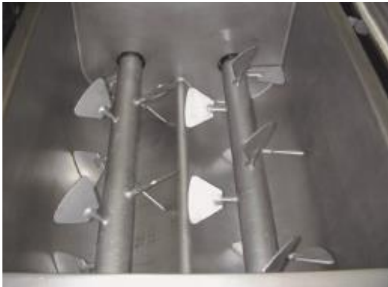
Kuva 3. Kaksi-akselinen lapasekoitin (Knipe & Rust 2014c, 1269.)
