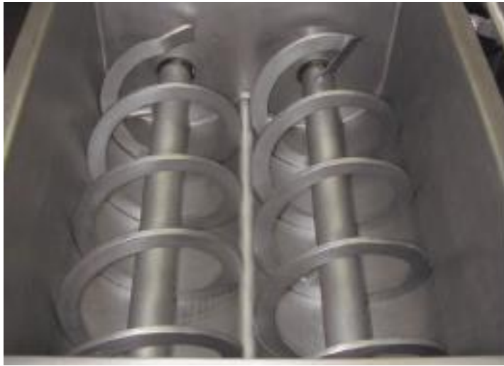
Kuva 4. Nauhasekoitin kahdella spiraalilla (Knipe & Rust 2014d, 1270.)
