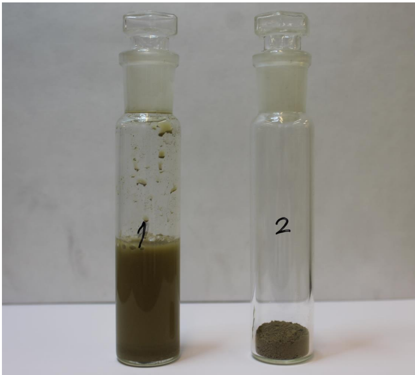
Kuva 5. Koeajoissa käytetyt pesupullot. Vasemmalla olevassa pesupullossa on jarosiitin ja veden seos ja oikealla olevassa pesupullossa on pelkkää jarosiittia.
