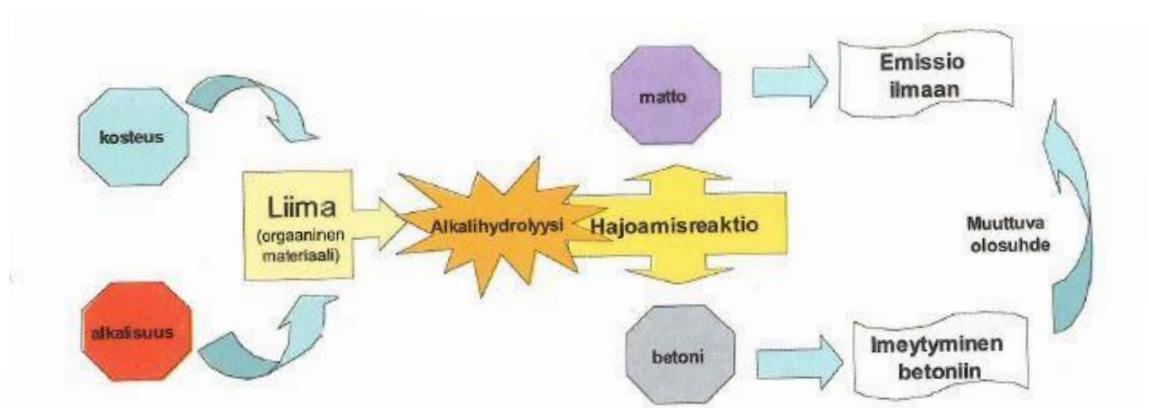
Kuva 14. Betonin kosteuden aiheuttamat emissiot mattoliimoissa (Merikallio et al. 2007)
