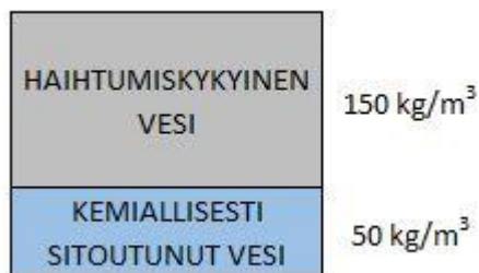
Kuva 3. Betonimassan esimerkki ainesmäärät
