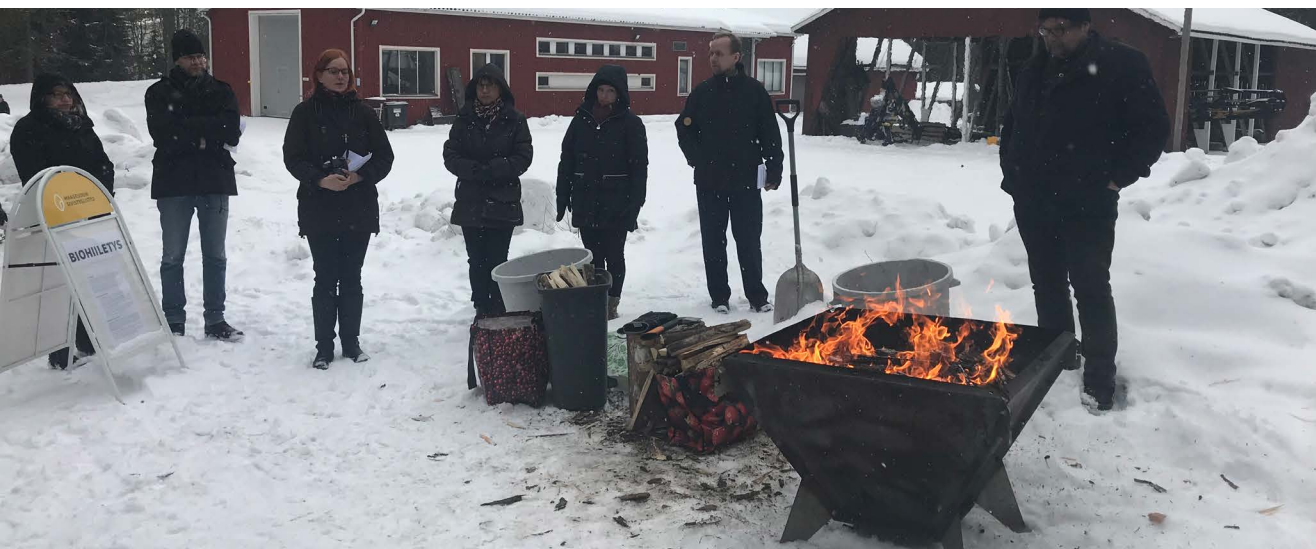
Kuva 2. Biohiilenpoltto kartiohiilettimessä. Kuva: Jussi Kilpinen.
