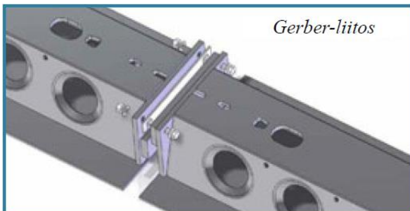
KUVA 1: Esimerkkikuva gerber-liitoksesta (Deltapalkin asennus – RT Tuotetieto)
