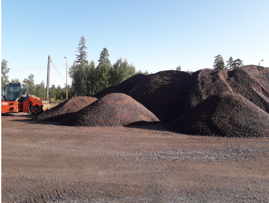
Kuva 10 Valmis kalliomurske # 0-16 Pyhtään asfalttiasemalla varastossa.
