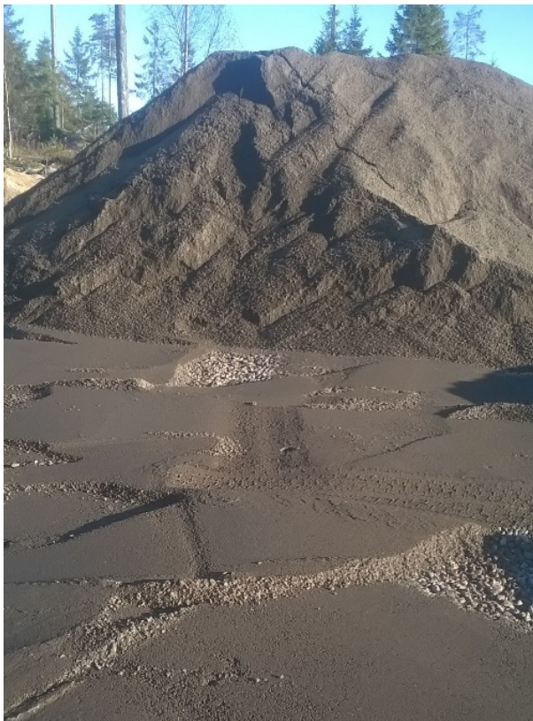
Kuva 2 Uusioasfalttiin lisättävää asfalttirouhetta # 0-11 mm
