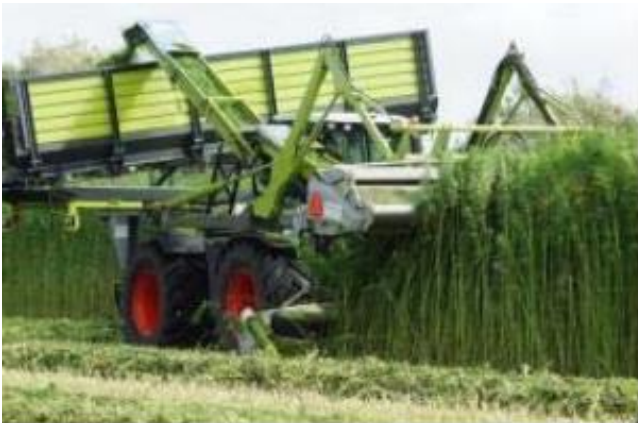
KUVIO 11. DunAgron ja Wittrockin kehittämä laite (Gusovius & Lühr 2017, 7)
