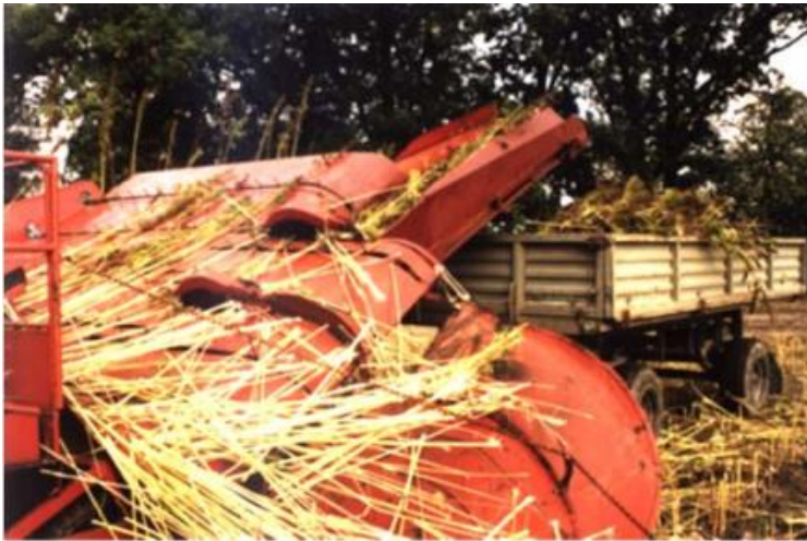
KUVIO 6. Puolalainen laite, jolla latvaosa voidaan korjata suoraan kærriyyn (Pari ym. 2015, 92)
