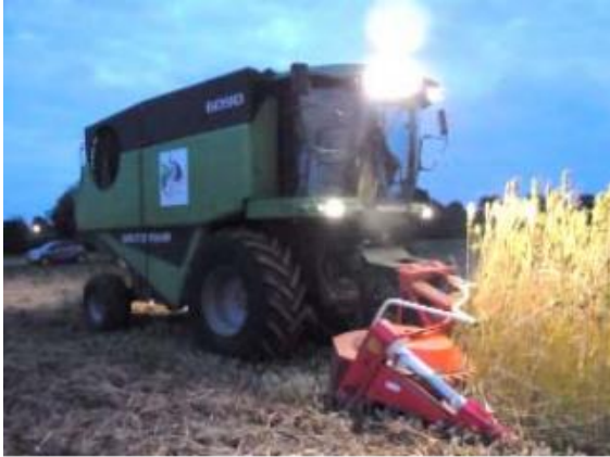
KUVIO 10. Hanfvollernter ja sen toimintaperiaate (Gusovius & Lühr 2017, 7)
