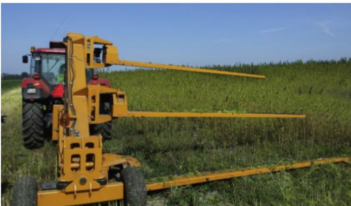
KUVIO 9. Tebeco Clipper 4.3 MMH, jossa leikkuupalkit kolmessa tasossa (Pari ym. 2015, 92)
