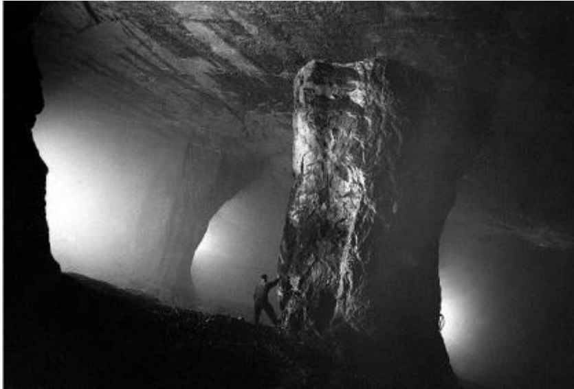
Kuva 3. Pilarilouhintaa Outokummun Keretin kaivoksessa. (Kaiva.fi 2014)
