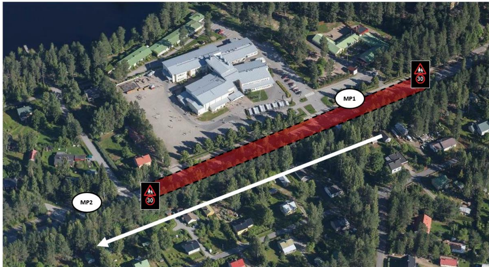
Kuva 33. Mittauspisteen 1 ja 2 sekä vaihtuvien opasteiden sijainti. Tuloksissa on käsitelty liikenne lännen suuntaan. Pohjakartta: (Jyväskylän karttapalvelu)
