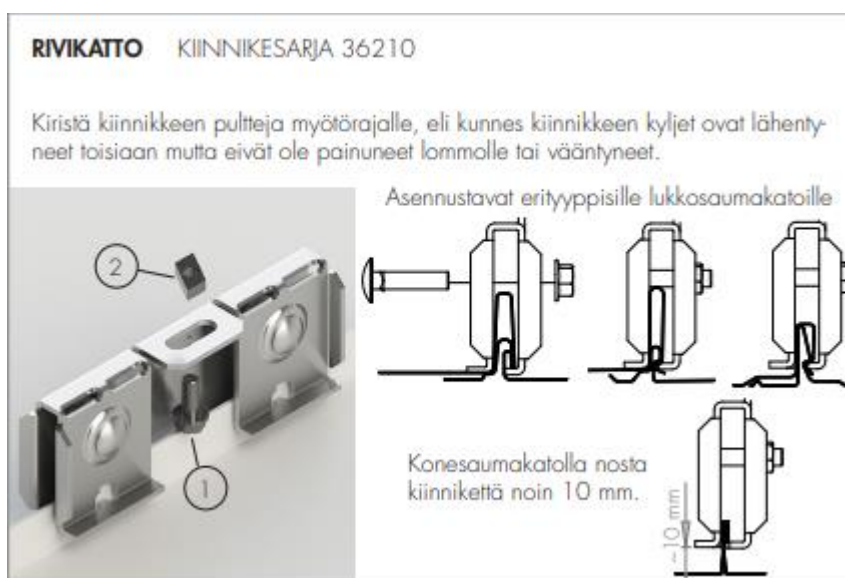
Kuva 8. Konesaumapeltikaton kiinnike (Orima Oy)
