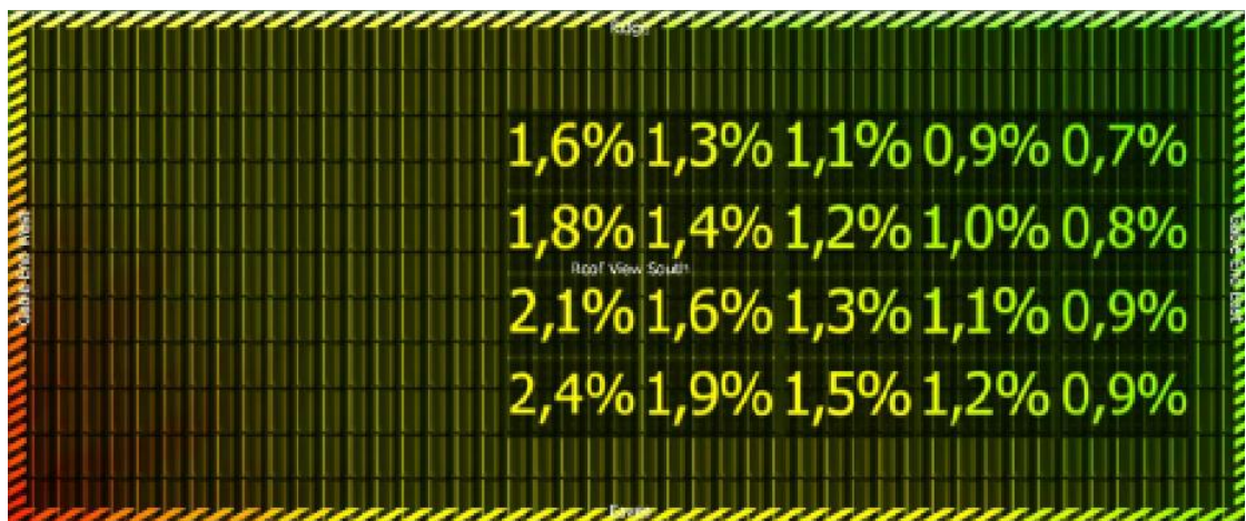
Kuva 16. Varjostuksien aiheuttamat tuoton alenemat paneeleissa PV-SOL-ohjelman mukaan
