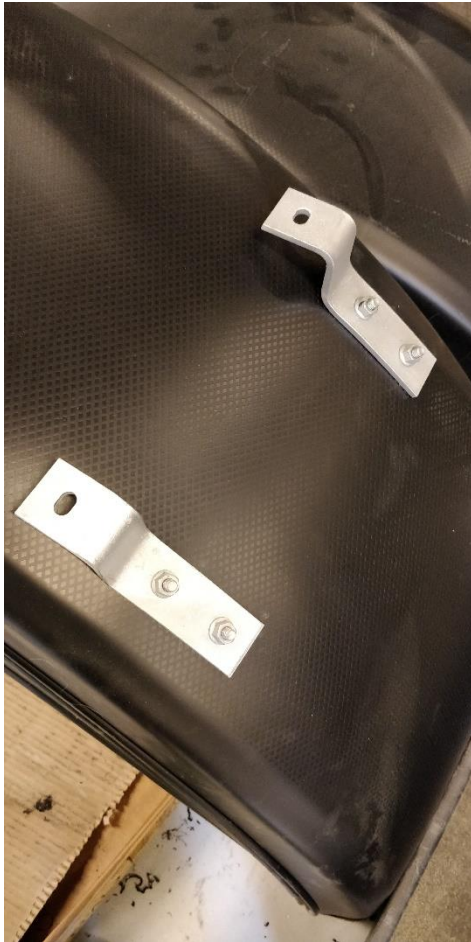
Kuva 22 OEM-kannakekokoontalon kannakkeet kiinni lokasuojassa.
