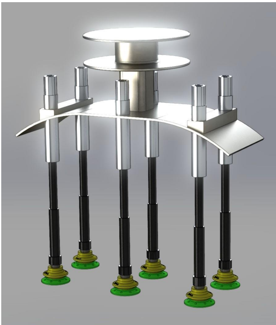
Kuva 12 Renderöity 3D-mallinnos pneumaattisen tarttujan konseptista.
