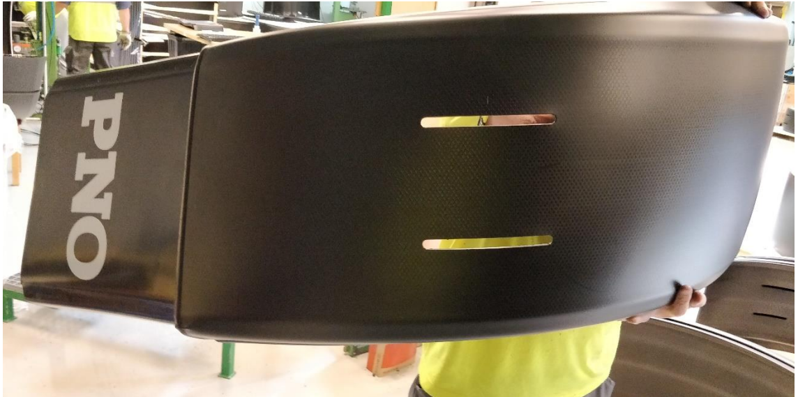
Kuva 5 Esimerkki lokasuojan taipumisesta nostettaessa.
