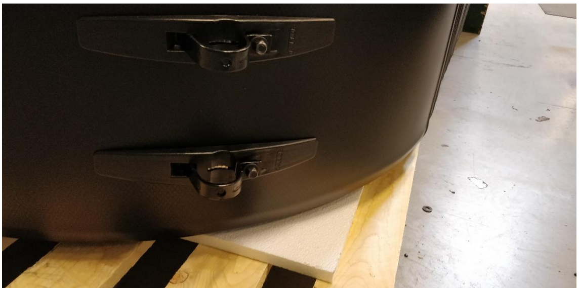
Kuva 6 Kannakkeet kiinnitettynä lokasuojaan.
