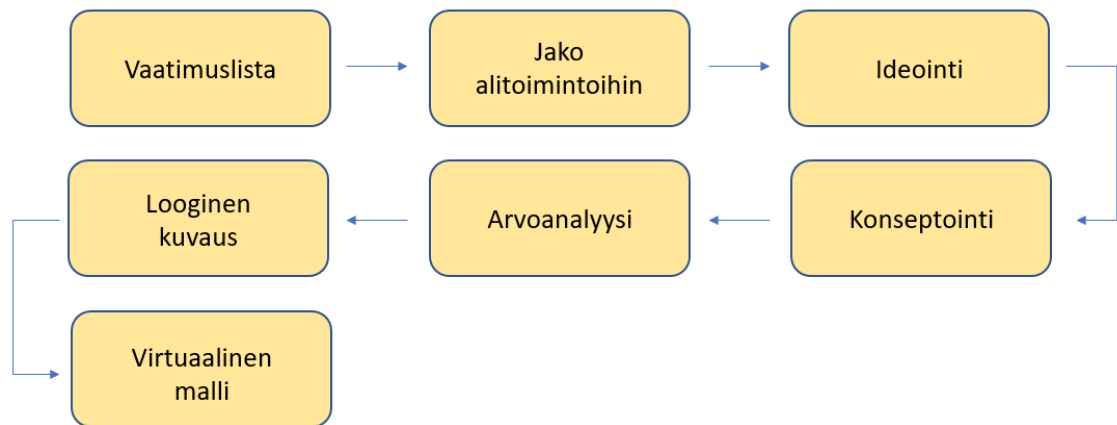
Kuva 4. Systemaattisen tuotekehitysprojektin perusrakenne, kuva mukailee Turun AMK, lehtorin Tommi Metson tunnilla esittämää kaaviota.
