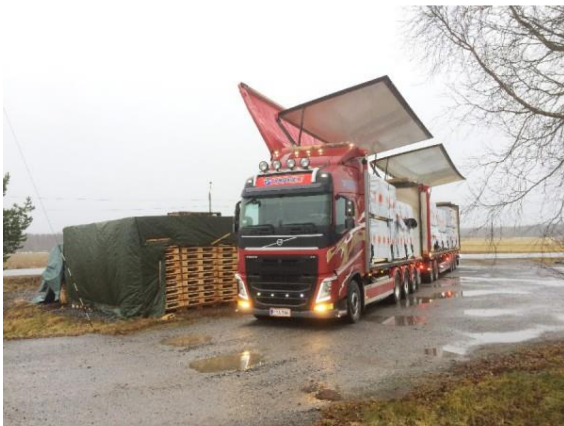
Kuva 5. Sivukippaava yhdistelmä sahatavarakuorma kyydissä (Pohjaset Oy 2018.)
