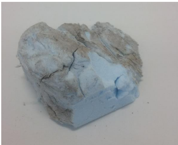
KUVA 2. Jätevirrasta kerätty XPS-näyte DE13, jonka todettiin sisältävän HBCD:tä
