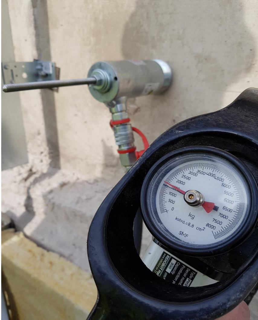
Kuva 3. Vetokokeita otettiin yhteensä 20 julkisivun rankojen kiinnityksistä.
