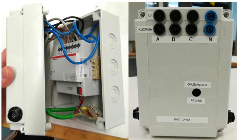
Kuva 36. Koteloitu KNX Energiamittari
