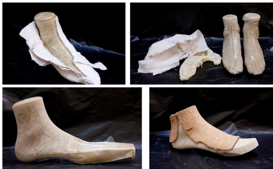
Kuva 21. Kenkälestin valmistusprosessin eri vaiheet.
