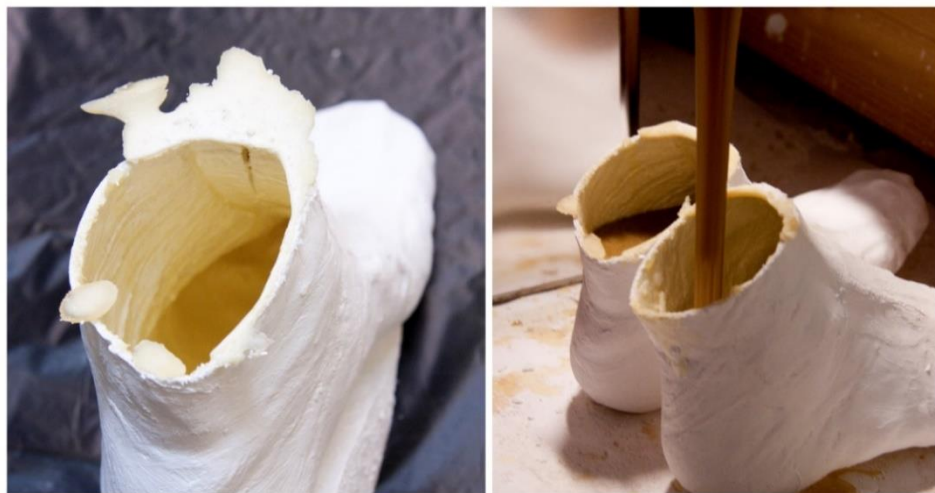
Kuva 18. Kipsimuotin erotusaine kerros (vasemmalla) ja Pedilen Rigid Foam 700:n valu (oikealla).
