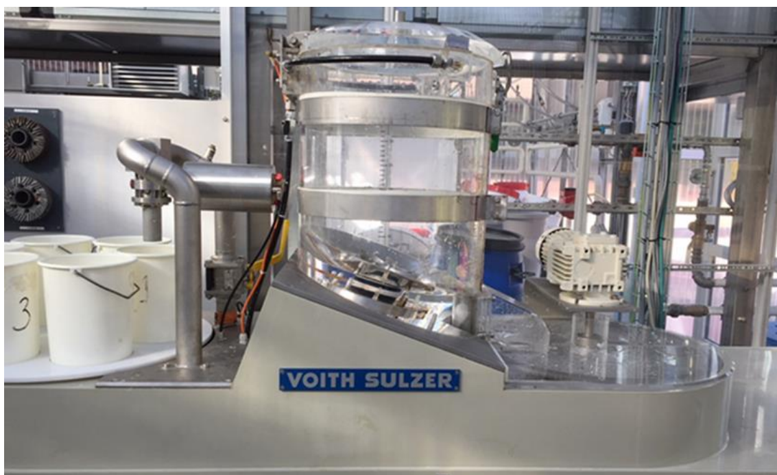
Kuva 9. Voith Sulzer -jauhin, keskellä sulppusäiliö ja jauhinterät
