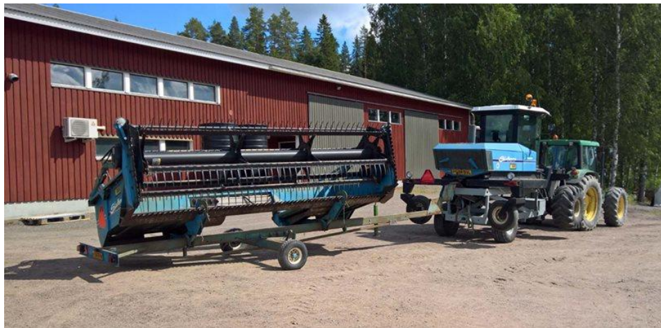
Kuva 4. Karheelleniittokone kuljetuskärryn päällä (Joensuu 2017)
