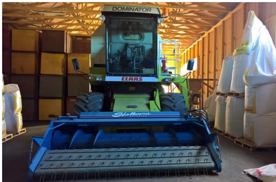
Kuva 6. Claas Dominator- leikkuupuimuri Shelbourne Reynolds- noukinpöydällä varustettuna. (Leppäkoski 2017)
