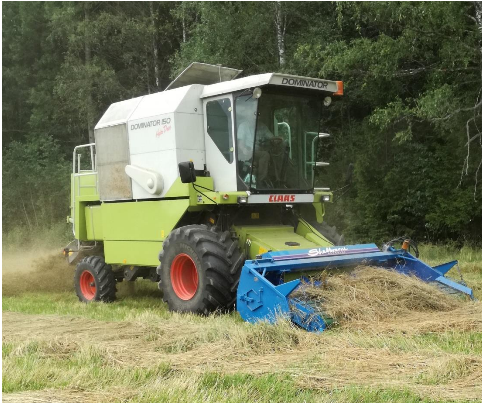
Kuva 8. Karheelle niitetyn kasvuston puinti sujui mallikkaasti. Kuvasta havaittavissa kasvuston kuivuus, pöly nousee silppurista. (Leppäkoski 2017)
