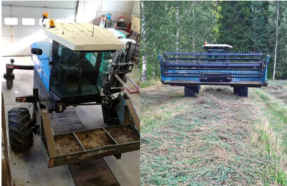
Kuva 7. Shelbourne Reynolds- karheelleniittokone ilman leikkuupöytää ja pöydän kanssa (Leppäkoski 2017)
