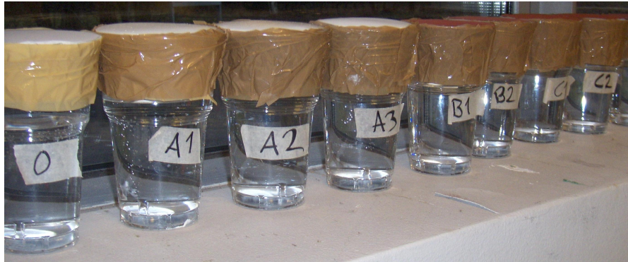
Kuva 12. Vesihöyrynläpäisevyyden tutkiminen mukitestillä.
