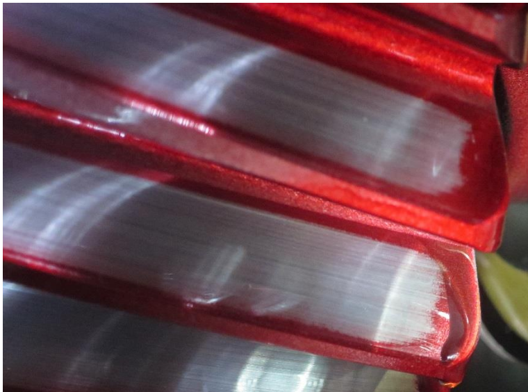
Kuvio 10. Kosketusväri kuvattuna koeajon jälkeen
