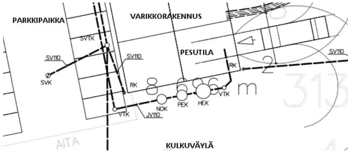
KUVA 7. Erotinjärjestelmän asennuspaikka. Pesutilasta tuleva purkuputki tulee jätevedentarkastuskaivoon (VTK), josta jätevesi menee hiekan- (HEK), öljyn-(PEK) ja näytteenottoaivon (NOK) kautta viemäriverkostoon.
