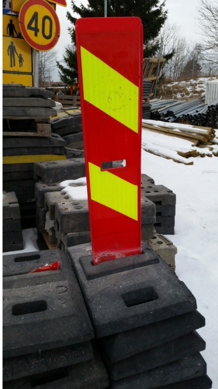
Kuva 7. Litteä sulkupylväs eli lamelli.
