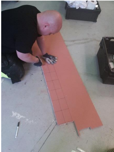
Kuva 30 Ensimmäisen koesarjaan kuuluvien eristelevypalasiin leikkaamista
