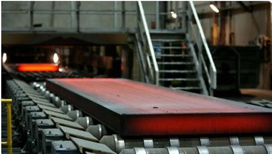
Kuva 6 Polttoleikattu aihio terässulattolla (MTV 2010)
