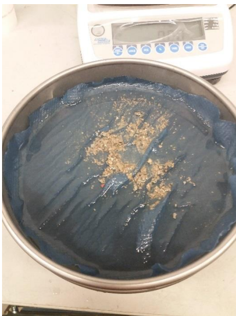
Kuva 35 Viimeisen mittausjakson aikana irronnutta pakkasrapautumaa
