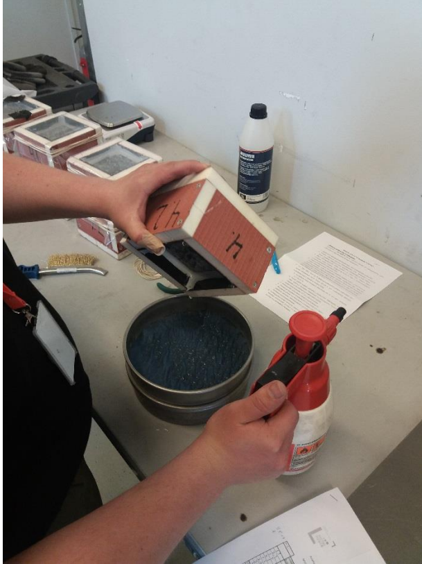
Kuva 31 Pinnasta irronneen aineksen valuttamista suodatinpaperille
