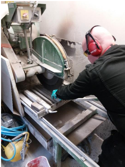
Kuva 22 Betonikappaleiden sahausta standardin vaatimaan mittaan
