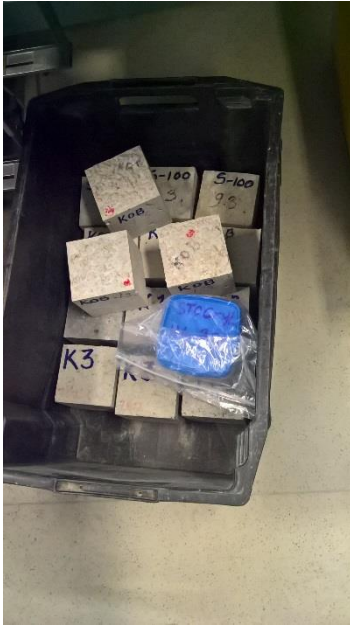
Kuva 13 Valmiit betonikuutiot kuivumisen jälkeen
