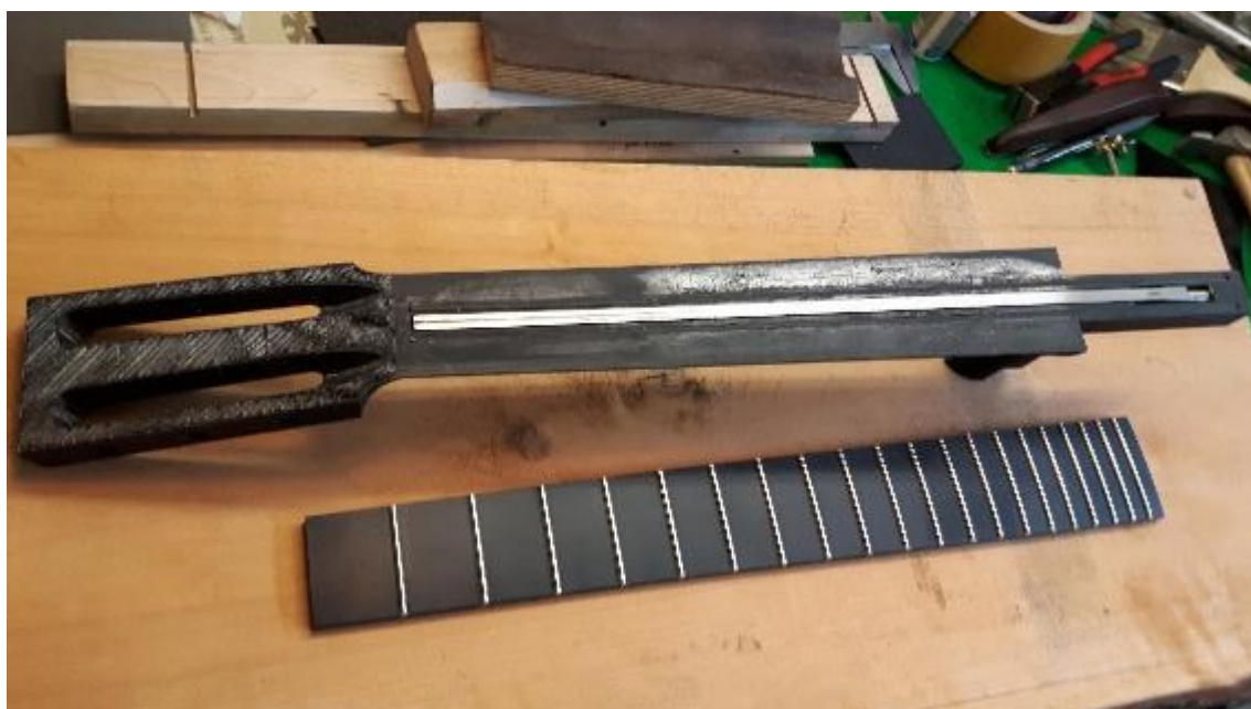
KUVA 8. Otelauta valmiina liitettäväksi tulostettuun kaulaan
