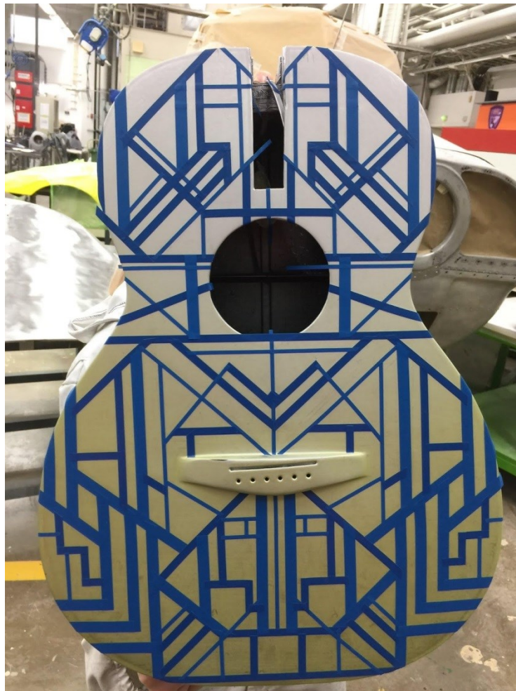
KUVA 12. Kitaran raidoitusmalli valmiina pinnoitusta varten. (Jari Väikkynen)
