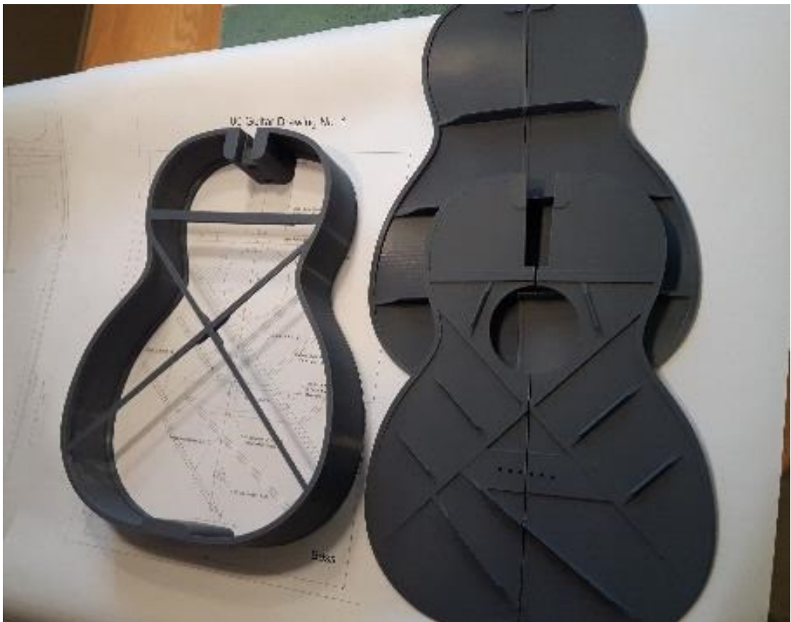
KUVA 6. Tulostettuja komponentteja verrataan alkuperäiseen työpiirustukseen
