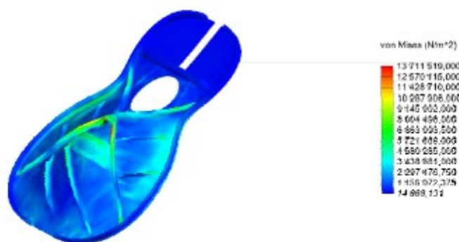
KUVA 19. Kannen stressianalyysi. (Santeri Halminen, 2016)
