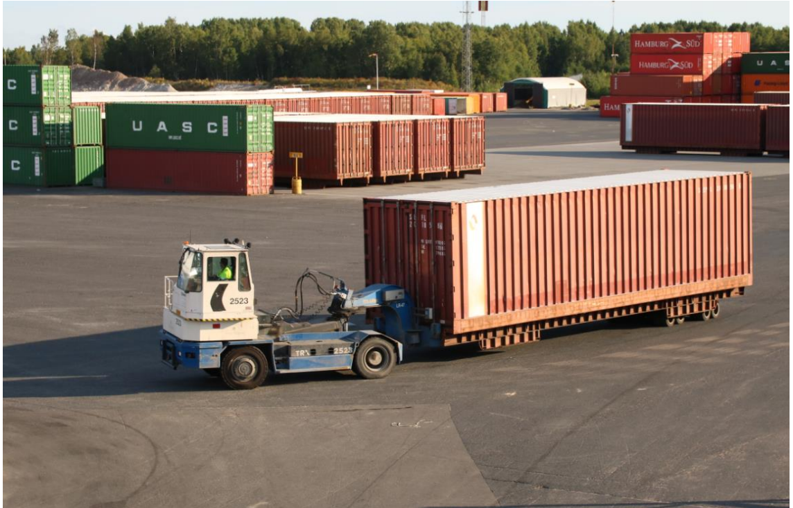
Kuva 2. Roro lastausta. Secut ajetaan Roluxeilla omalle paikalleen.
