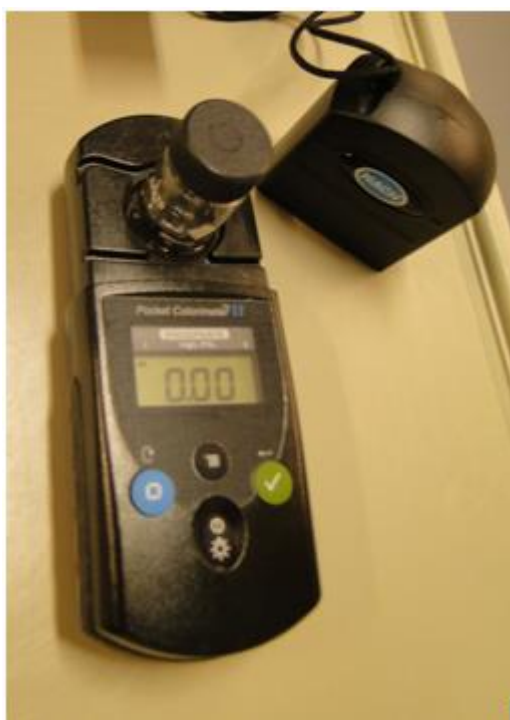
KUVIO 6. Fosfaatin mittaukseen käytetty Hach Pocket Colorimeter II -mittari
