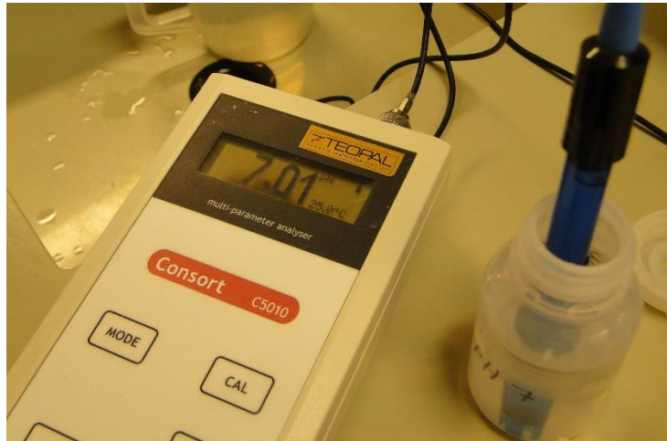
KUVA 3. Anturi on pH 7 pitoisessa liuoksessa ja mittarilukema tasaantuu lähelle todellista arvoa
