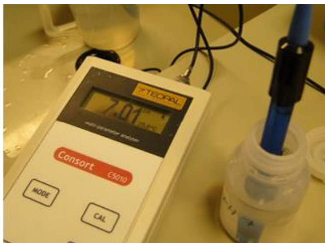
KUVIO 5. pH:n mittaukseen käytetty Teopal Consort C5010 -mittari
