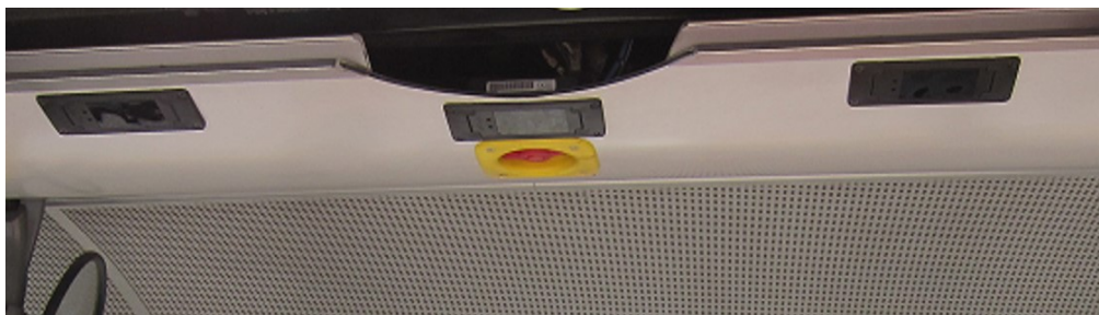
Kuva 10. Matkustajalaskentalaitteet (DILAX) ovat sijoitettuina bussin ovipaneelien yläosaan (HSL. n.d.).
