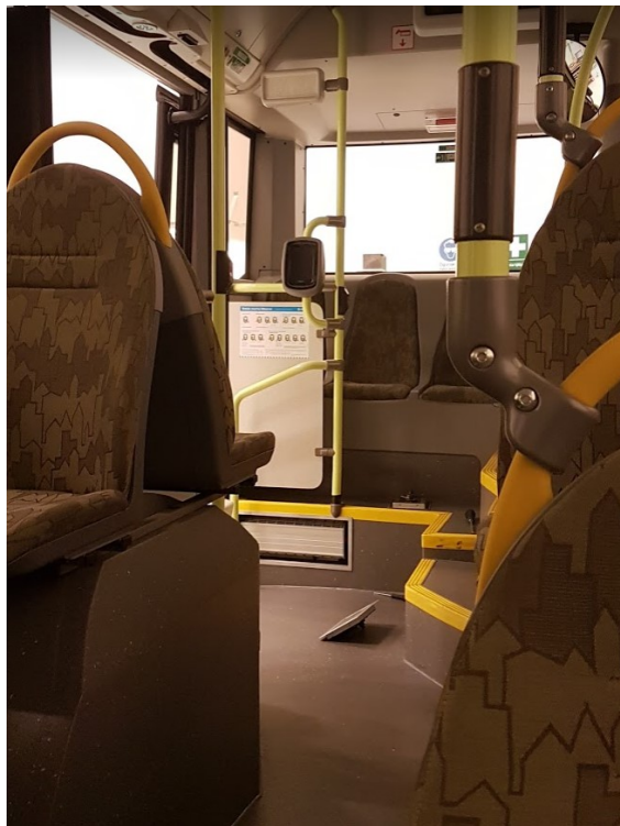
Kuva 37. Volvon bussimallin 7900 vm.2017 lattiamalliratkaisu (täysmatala) kuvattuna tehtaalla. Huomioitavaa kuvassa on lippujen leimälaitteiston sijainti sekä lattiatyyppiratkaisun luoma avaruus -> nopeuttavia tekijöitä pysäkeillä. (Vasiljev 2017)
