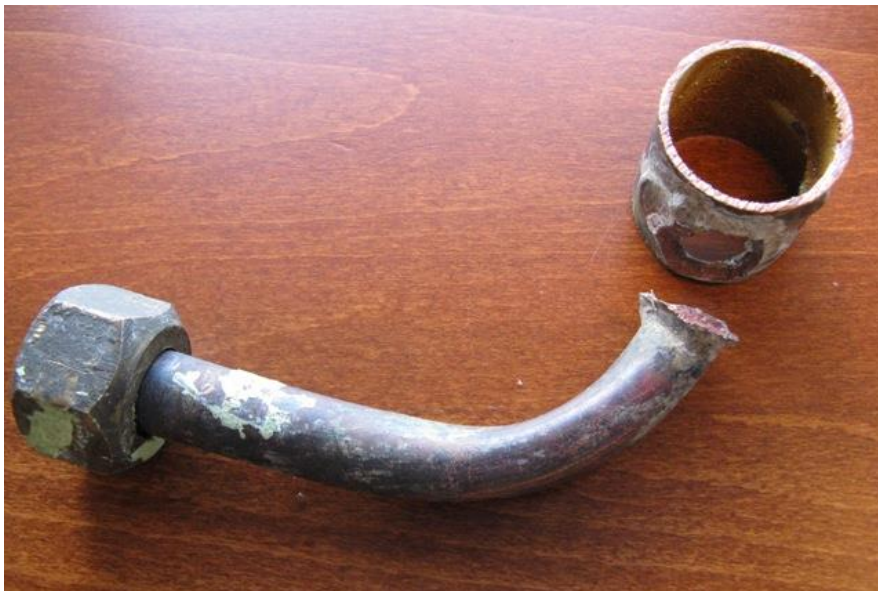
Kuva 19 Sinkkikato katkaissut putken liitoksen. (Teknoplan www-sivut. Viitattu 2017)
