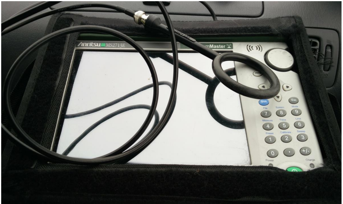
KUVA 2. Anritsu MS2713E -spektrianalysointilaitteeseen ja mittapää magneettikentän mittaamiseen
