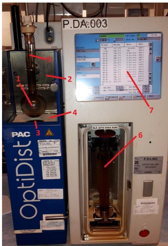
Kuva 1. Työssä käytetty sähkölämmiteinen tisluslaitteisto.
