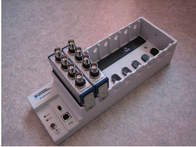
Kuva 12. National Instruments CompactDAQ USB -tiedonkeruusysteemi (Austin, Texas)
