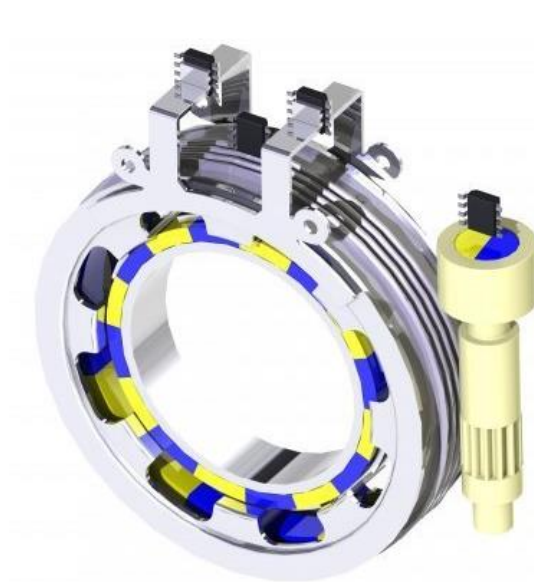
KUVA 2. vääntömomenti ja kääntökulma sensorin mahdollinen rakenne (movingmagnet.com)
