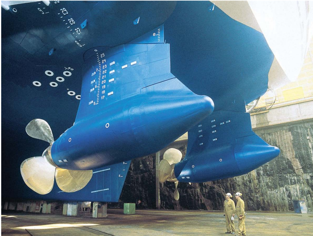
Kuva 21. Kaksi 19,5 Mw Azipod sähkömoottori-/potkuriratkaisua valtameriristeilijässä. (kuvalähde: http://www.abb.com/cawp/seitp202/c181fc2597fd7fdec12570ce00438572.aspx )
