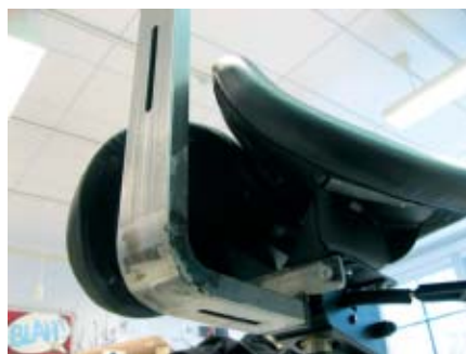
36 B. Taivutetusta profiiliputkesta valmistettu runko, jossa jyrskityt urat liukumekanismille
