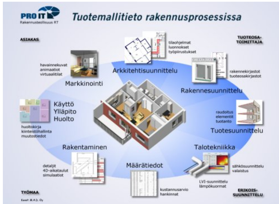
KUVA 1. Rakennushankkeen tuotemallipohjainen tietokanta (ProIt 2006.)
