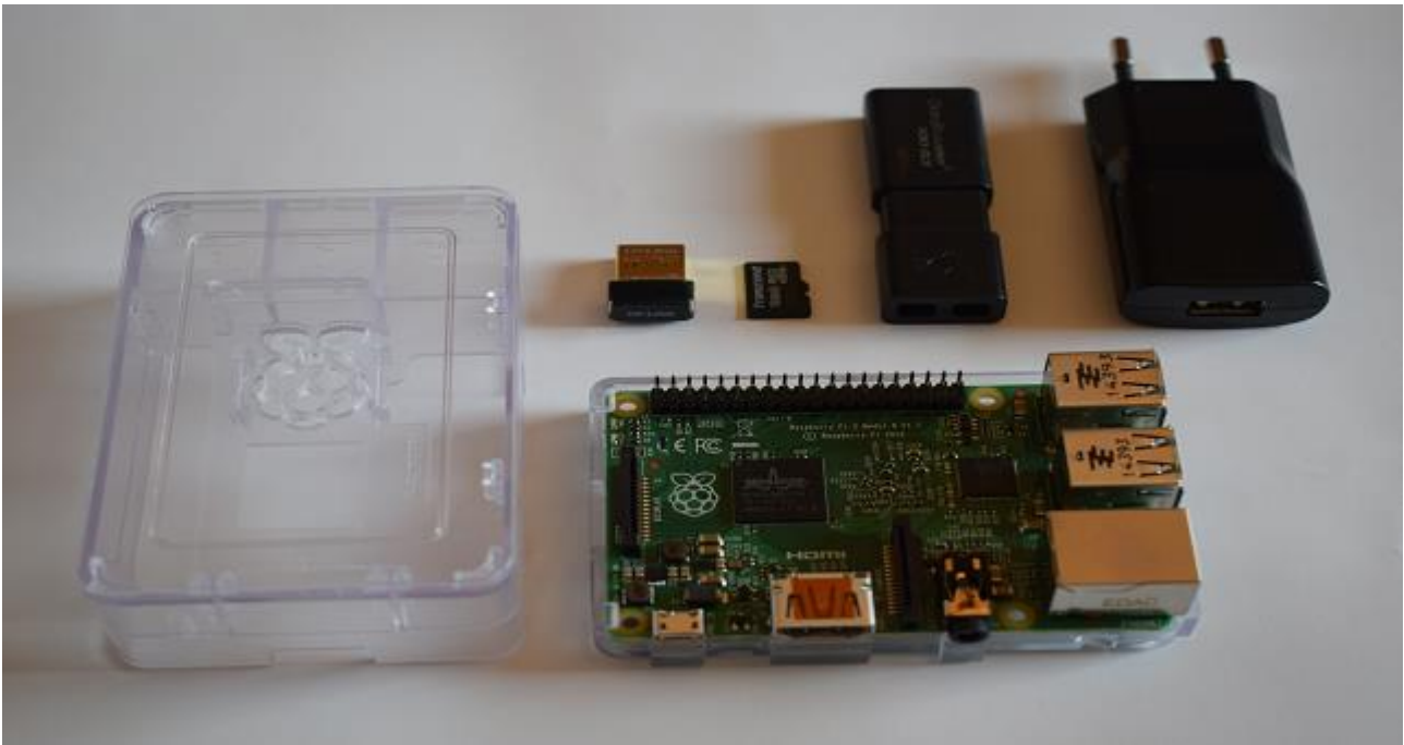
KUVA 12. Kehityksen laitteisto (Suojakotelo, Wi-Fi-sovitin, MicroSD-muistikortti, muistitikku, verkkovirtalaturi ja Raspberry Pi 2 Model B)
