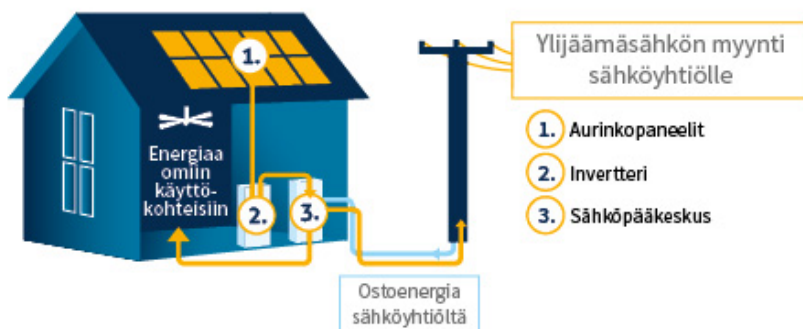
Kuva 6. Aurinkosähköjärjestelmän periaatekuva (Oulun Energia, 2016)
