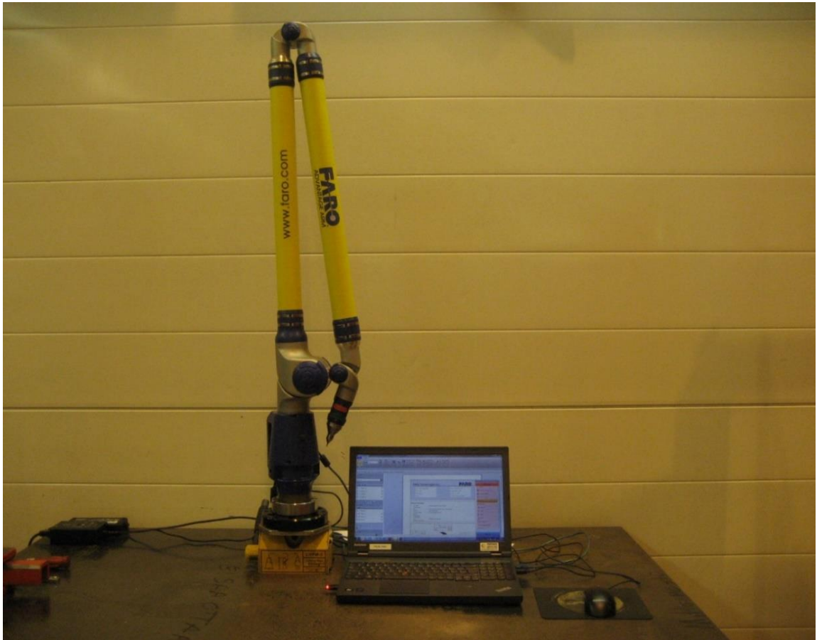
Kuva 1. Faro-mittauslaite ja tietokoneessa mittausohjelma.
