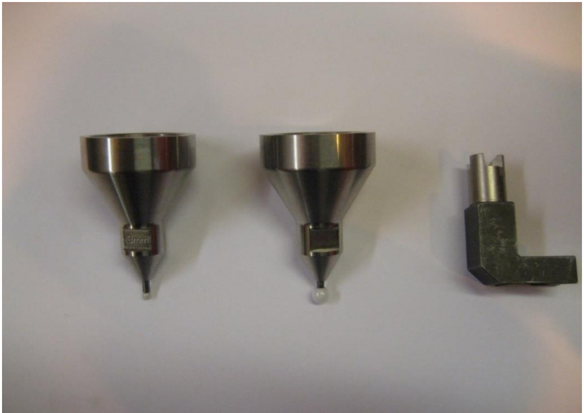
Kuva 2. Mittauslaitteen mittauspääät ja kalibrointimalja.
