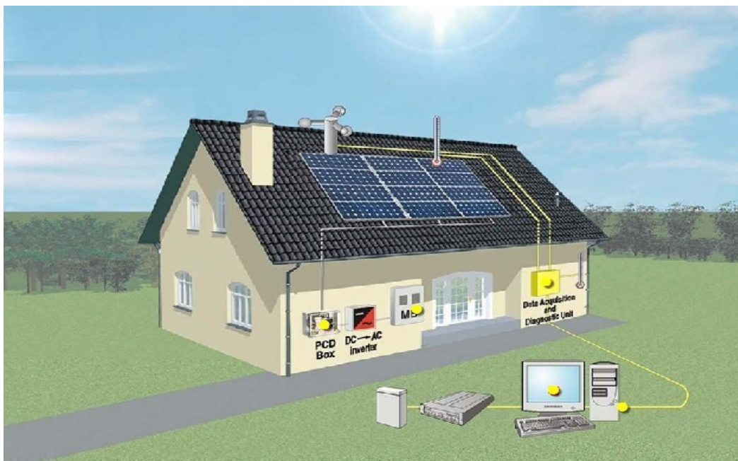
Kuvassa 13 on havainnollistettu ylijännitesuojauksien sijoituspaikat keltaisella [20.]
