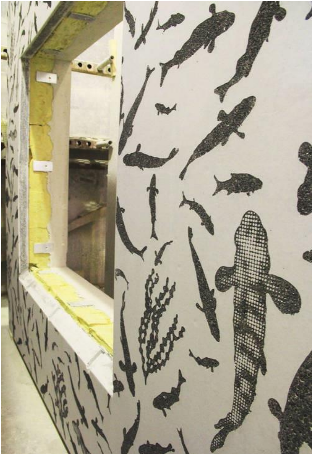
Kuva 10. Valmis sandwich-elementti graafisella betonipinnalla [22.]
