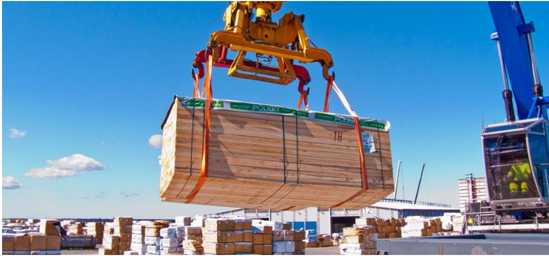
Kuvio 12. Sahatavarapaketti ja puoliautomaattinen sahatavaranostin (Herman Andersson Oy n.d.)
