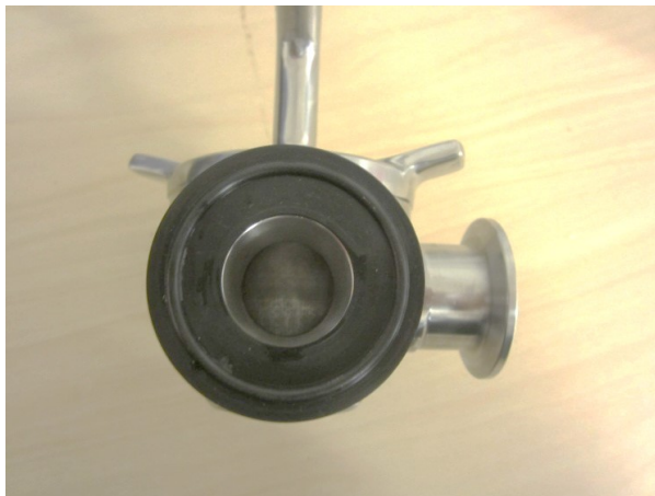
KUVA 11. B-asento: venttiilin kara estää virtauksen vasemmalle
