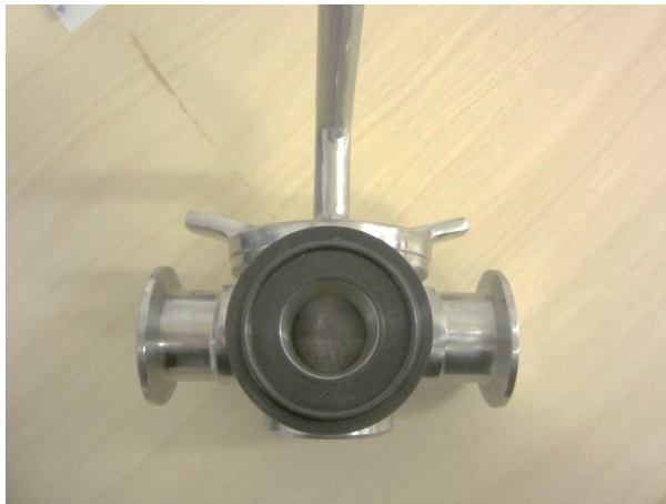
KUVA 15. D-asento: venttiilin kara estää pumppaamisen venttiilin läpi
