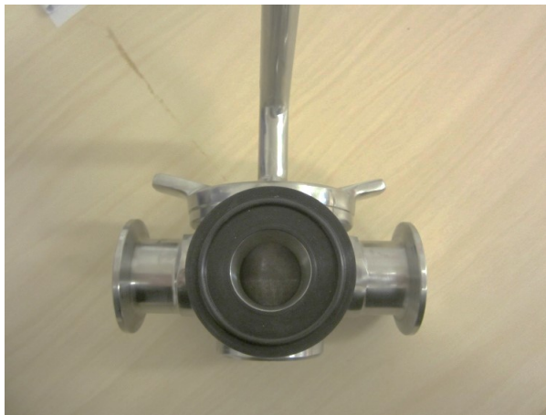
KUVA 15. D-asento: venttiilin kara estää pumppaamisen venttiilin läpi
