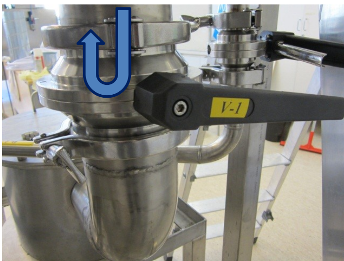
KUVA 4. Kahvan asento, kun sulkuventtiili on kiinni
