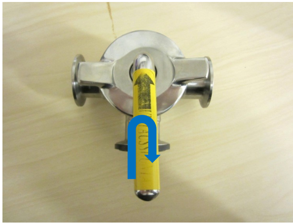
KUVA 14. D-asento, pumppaus venttiilin läpi on estetty
