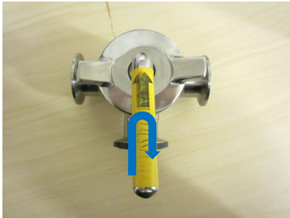
KUVA 14. D-asento, pumppaus venttiilin läpi on estetty
