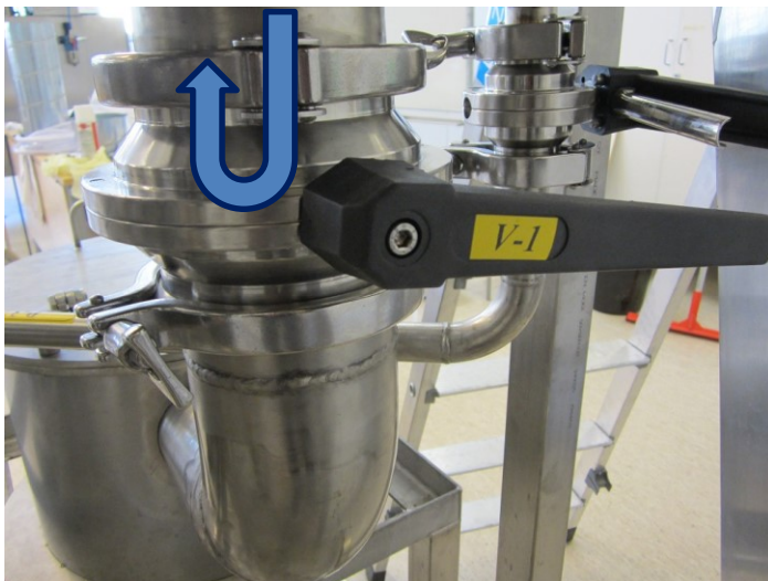
KUVA 4. Kahvan asento, kun sulkuventtiili on kiinni
