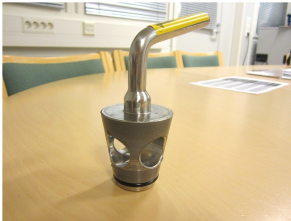
KUVA 13. C-asento: venttiilin kara sallii pumppaamisen oikealle ja vasemmalle
