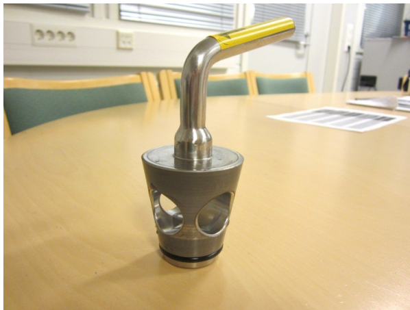
KUVA 13. C-asento: venttiilin kara sallii pumppaamisen oikealle ja vasemmalle
