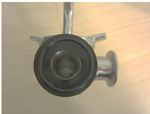
KUVA 11. B-asento: venttiilin kara estää virtauksen vasemmalle
