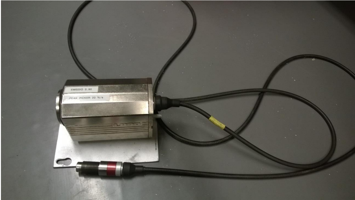
KUVA 8. Käytössä oleva referenssikuituoptiikka
