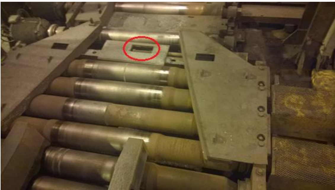
KUVA 13. Mittausaukko näkyy palkin keskellä olevana aukkona
