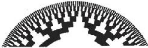
KUVA 26. Absoluuttianturin kiekon rakenne (17)
