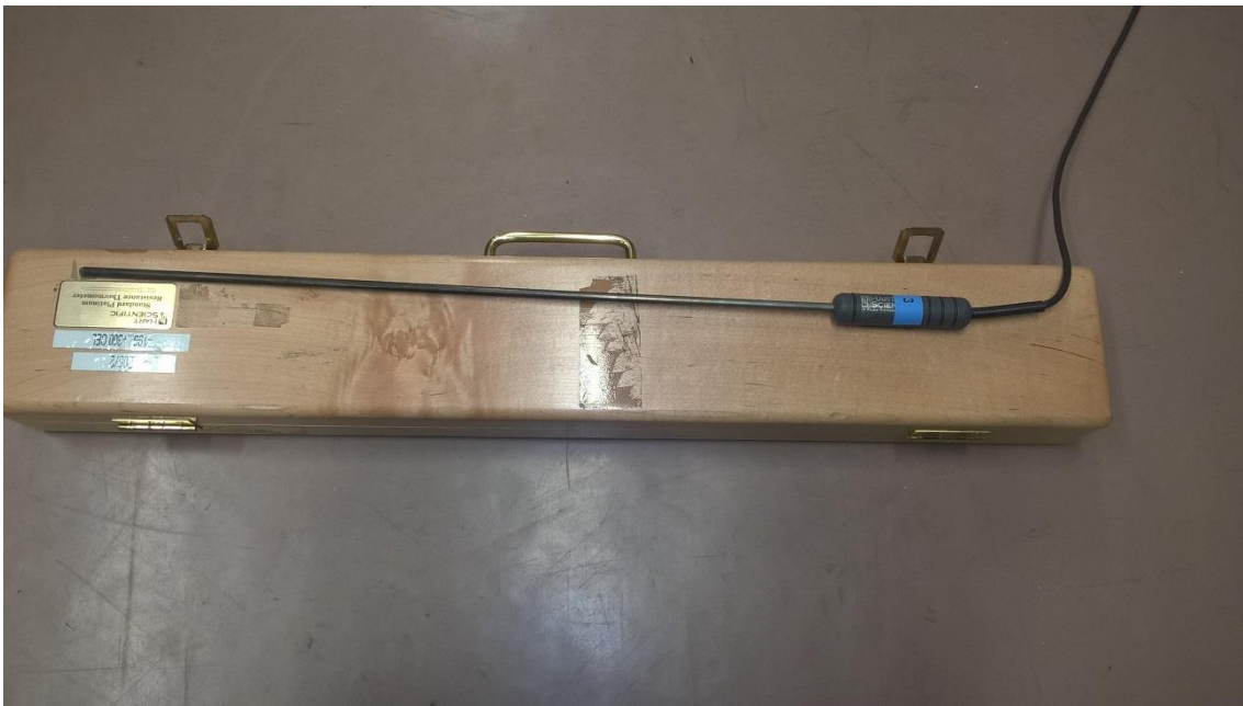
KUVA 10. Referenssianturina käytetty PT-100-lämpötila-anturi
