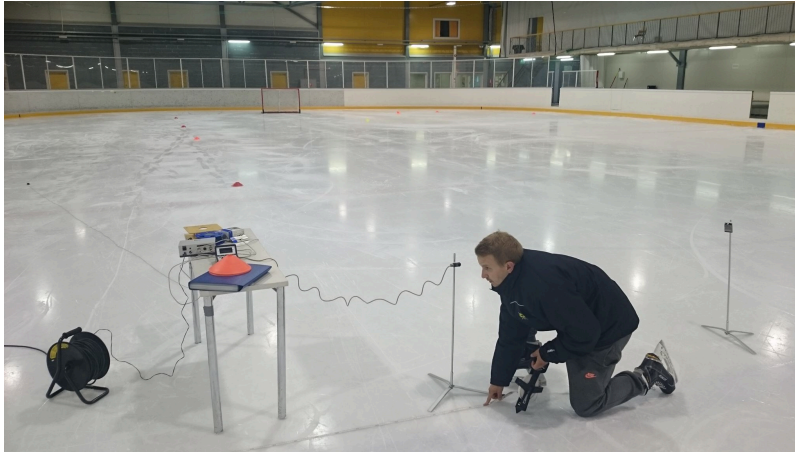
Kuva 7. 30 metrin luistelutestiradan vakiointi mittaamalla
