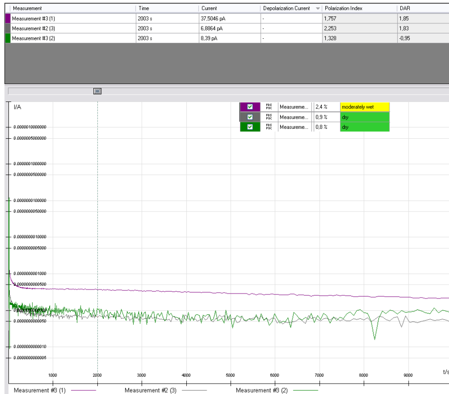
Kuva 37. PDC-data kuvasta 36 osoittaa miksi vihreän käyrän mittaus on epäonnistunut. Polarisaatiovirrat ovat altistuneet häiriöille. Violetin käyrän PDC-data on tasainen ja puhdas.
