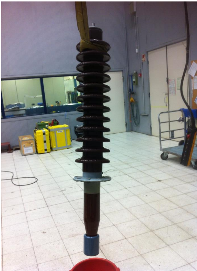
Kuva 18. ASEA:n valmistama 123 kV:n läpivientieristin. Kuvan läpivientieristimellä on ikää noin 30 vuotta. Kuva otettu koestuksien yhteydessä.
