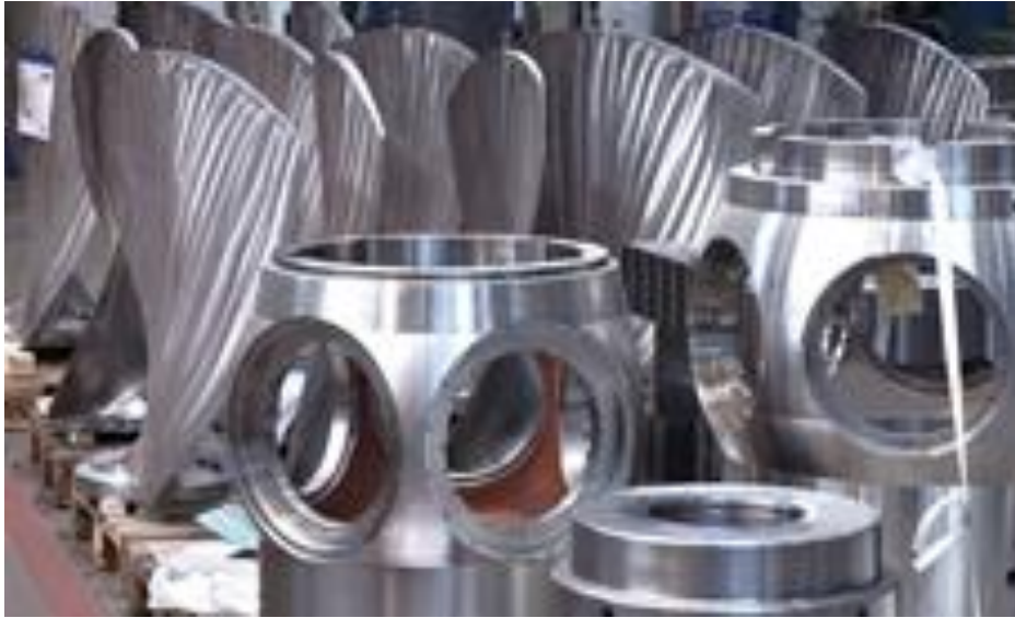
KUVA 4. Juoksupyörän napa- ja siipimalleja (Andritz Group, 2012)
