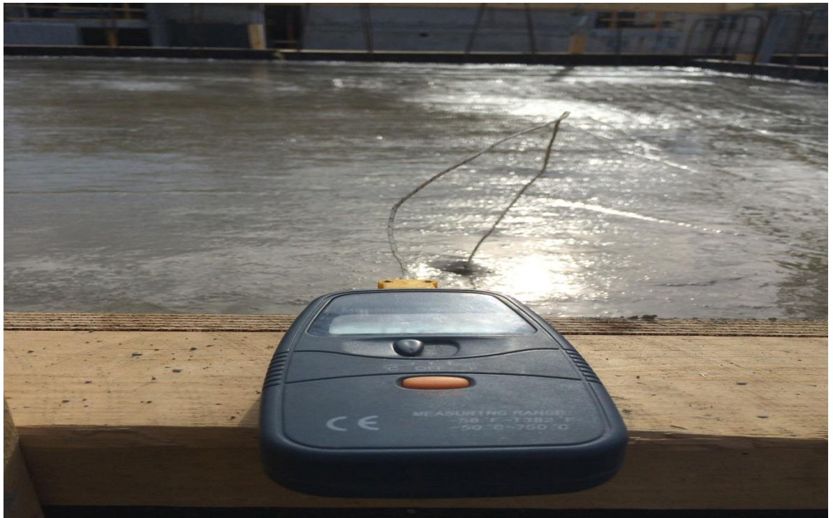
Kuva 3. Betonin lämpötilan seuranta (Vaaramo 2014)
