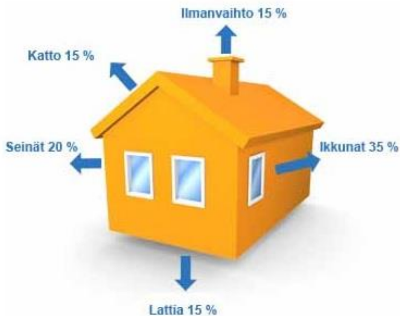
Kuva 4. Lämmön siirtyminen talosta ulos [5.]
