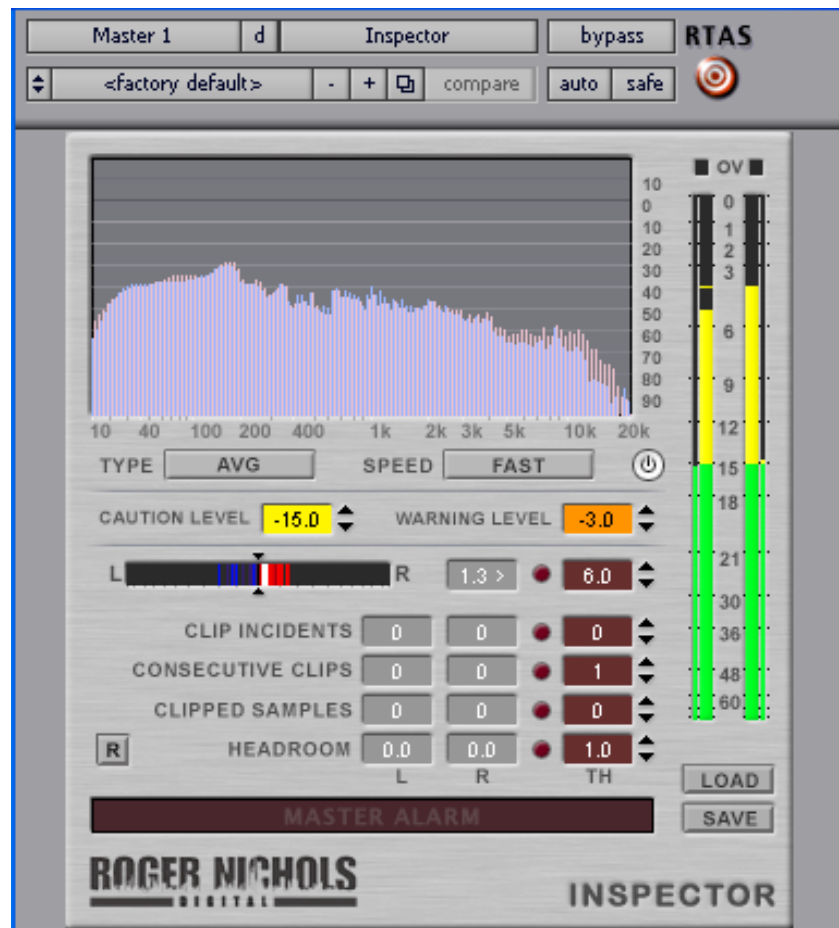
KUVA 4. Roger Nicholisin suunnittelema Inspector -mittari jonka yläosassa spektrianalysointtori. Spektrianalysointtorin vaak-akselilla kuuloalueen taajuudet hertseinä ja pystyakselilla äänenvoimakkuus desibeleinä.
