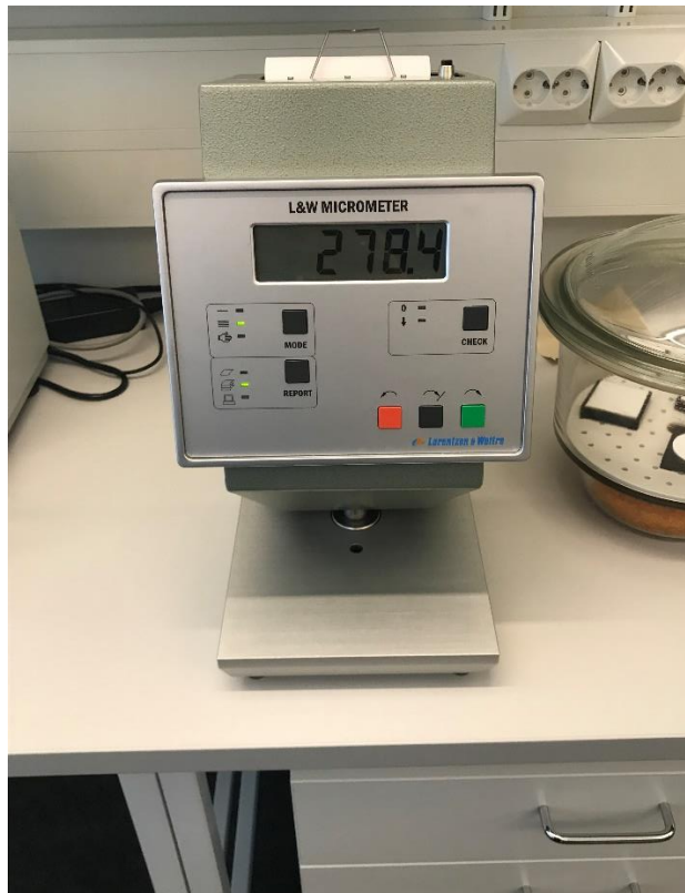
Kuva 4: Lorentzen & Wettre Micrometer -paksuusmittauslaite
